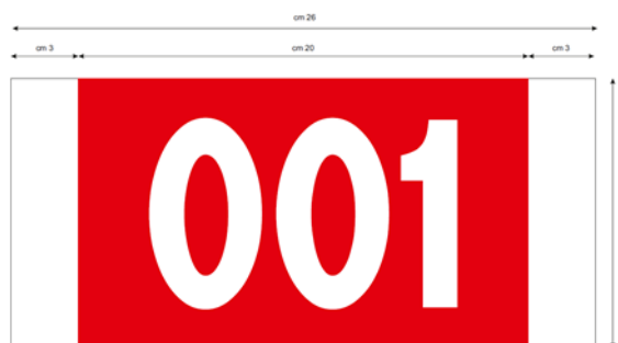
Figura 3 - Esempio di targhetta per l'identificazione del concio
